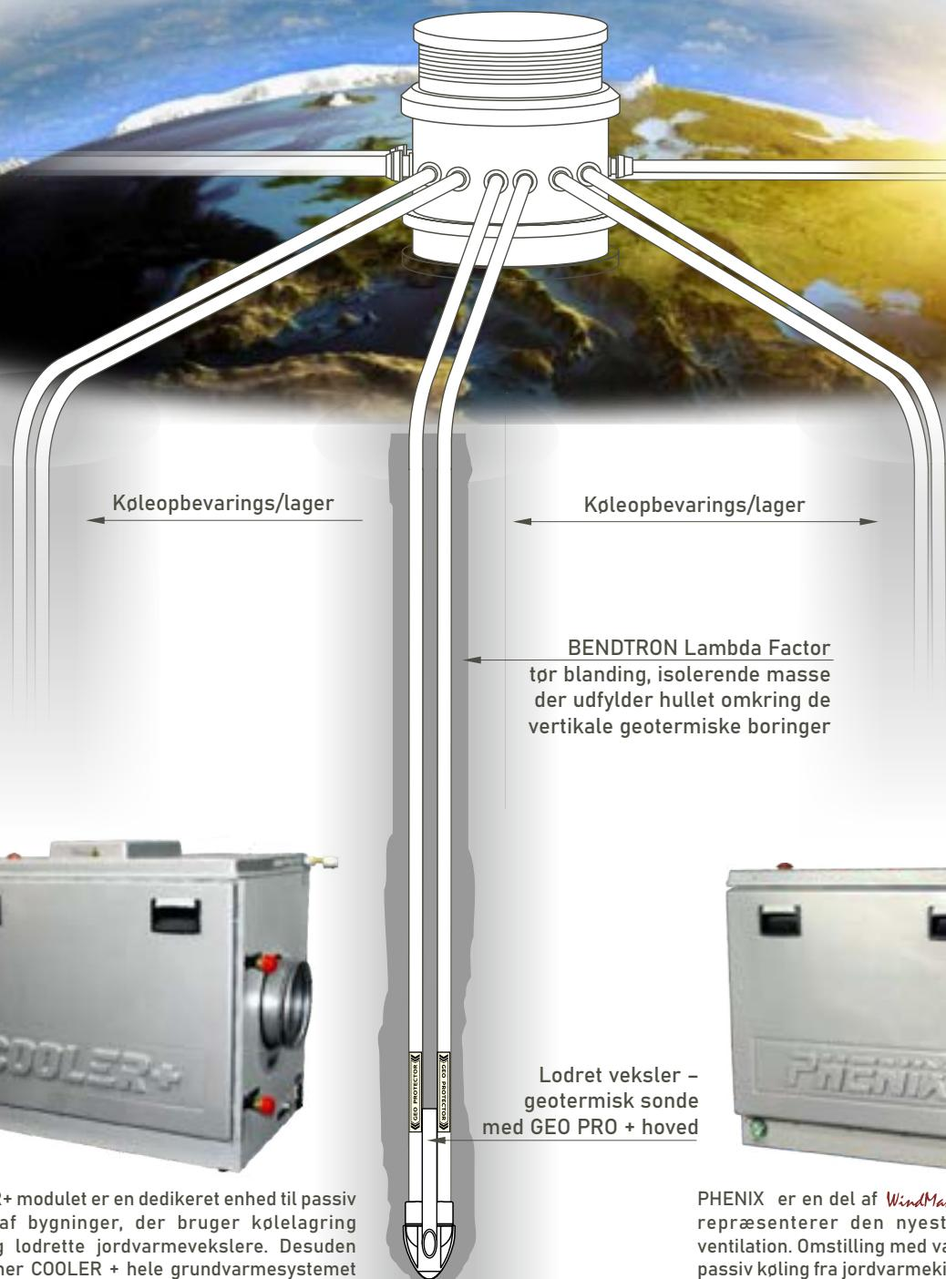
COOLER+ modulet er en dedikeret enhed til passiv køling af bygninger, der bruger kølelagring omkring lodrette jordvarmevekslere. Desuden gendanner COOLER+ hele grundvarmesystemet inden hver sæson.
