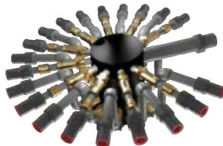
geotermisk cylindrisk HDPE 100 RC/Cu manifold med radiale manifoldsektioner. Indesluttet i et HDPEbrøndkammer. Samlerafsnittene (SK) passerer vinkelret gennem brøndkammeret i par i en vandret række - ventilsektion ved siden af flowmeteret. Produktet er som standard udstyret med separatorer, der muliggør rensning, påfyldning, udluftning og service af installationen. Hver brønd lukkes med et isoleret PE brønddæksel som drejes på.
