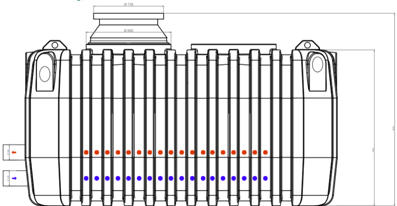
Fig. 37. 36-vejs Terra PRO COMBO kammer med flowmålere. Set fra siden. Hmin = 200 cm
